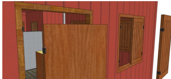
รูปที่ 2.37 ประตู-หน้าต่าง สามารถถอดประกอบได้ (ที่มา: ณิชวิชญ์, 2557)
