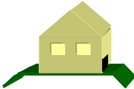
รูปที่ 2.24 ถมดินเพื่อสร้างบ้าน (ที่มา: FEMA, 2014)
